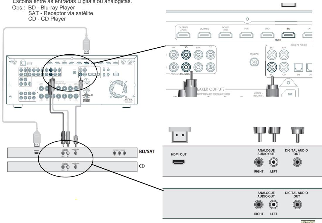
2. Conecte a saída "Output" de seu receiver à conexão de entrada de sinal de seu televisor ou outro dispositivo de vídeo que esteja sendo utilizado nessa configuração conforme o tipo de sinal utilizado (Hdmi, Digital, Analógico).
